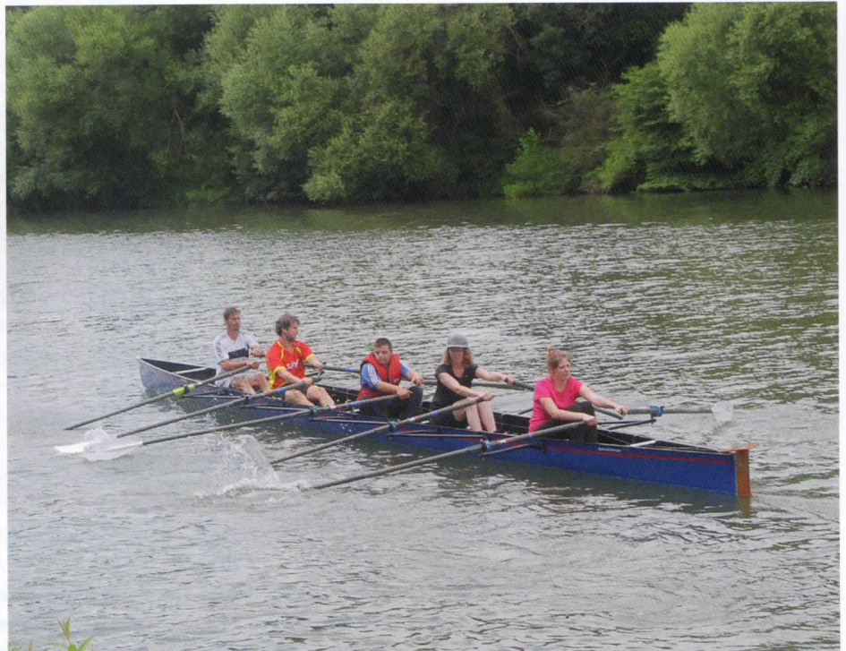
Der „Includer“ des RC Nürtingen hat neben einem verstärkten Fußraum auch einen fünften Ruderplatz, auf dem der Trainer das Boot notfalls allein zurückrudern kann. Foto: privat
